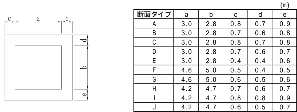
図 3.3.3に断面タイプと各函渠ブロックを示す。
